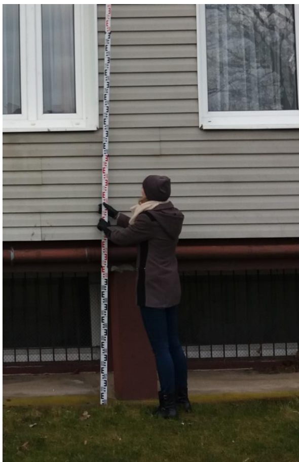
FOT. 2 POMIAR WYSOKOŚCI BUDYNKU PRZY CZĘŚCI PODPIWNICZONEJ
