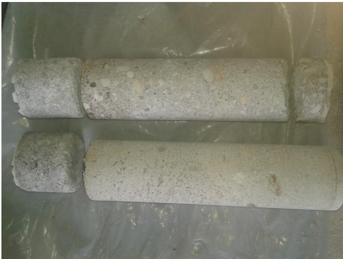
FOT. 8 ODWIERTY nr 1, 2 i 8 STROP NAD PARTEREM
