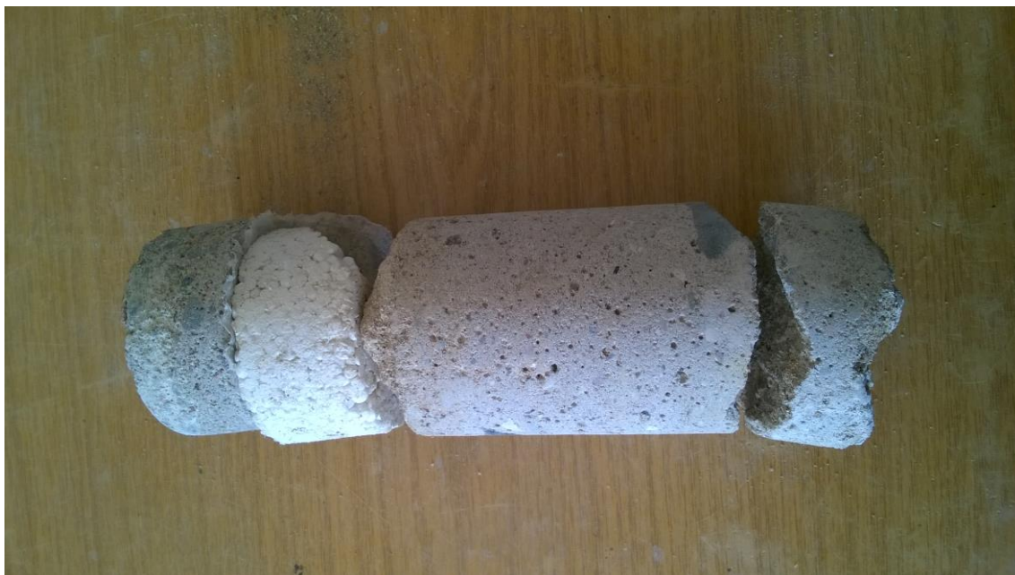
FOT. 7 ODWIERT nr 3 POSADZKA PARTERU
