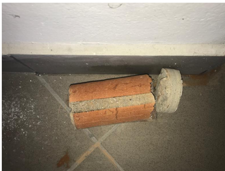
FOT. 13 ODWIERTY nr 3 ŚCIANA POPRZECZNA PIWNIC
