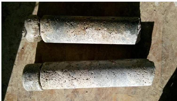
FOT. 9 ODWIERTY nr 2 ŁAWA FUNDAMENTOWA
