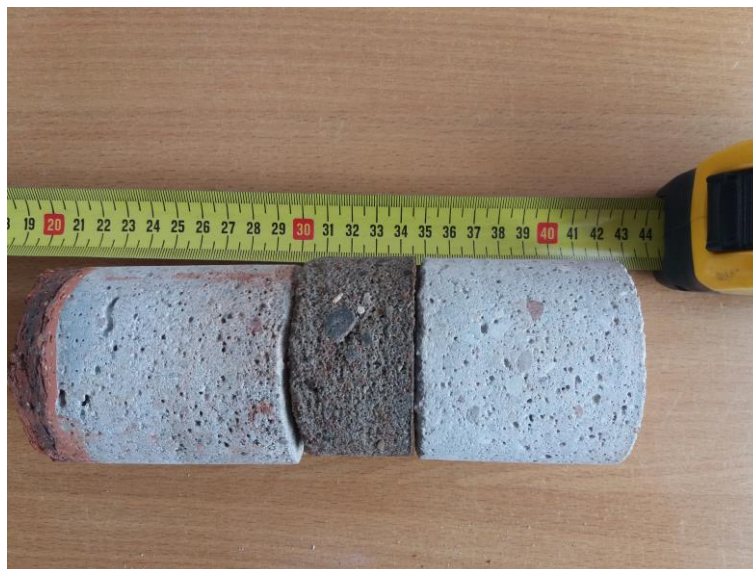
FOT. 10 ODWIERTY nr 1 STROP NAD PIWNICĄ
