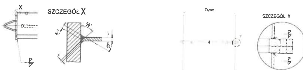
Rysunek 3.2. Standardowa konstrukcja głowicy podpory i kołnierza łączącego
