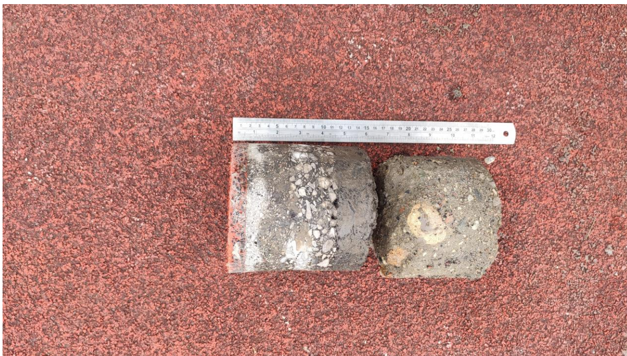
Fot. 1. Rdzeń z otworu F1
