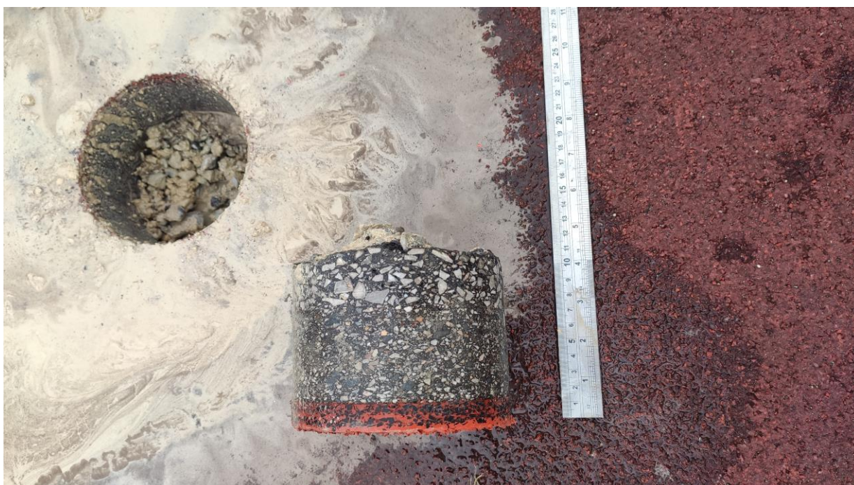
Fot. 4. Rdzeń z otworu F4
