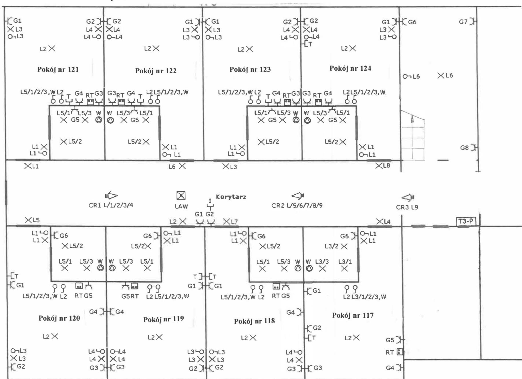
RT-gniazdo radio-telewizyjne T-gniazdo telefoniczne RJ-11 I-gniazdo internetowe RJ-14 W-wentylator G-gniazdo 230 V L-lampa,łącznik CR-czujnik ruchu LAW-Lampa osw. awaryjnego
