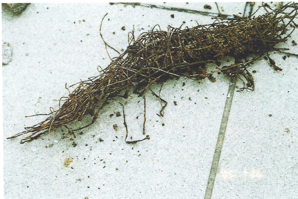
FOT. 30. ODKRYWKA NR 4. SIATKA METALOWA SILNIE SKORODOWANA WYCIĄGNIĘTA Z RYNIENKI.
