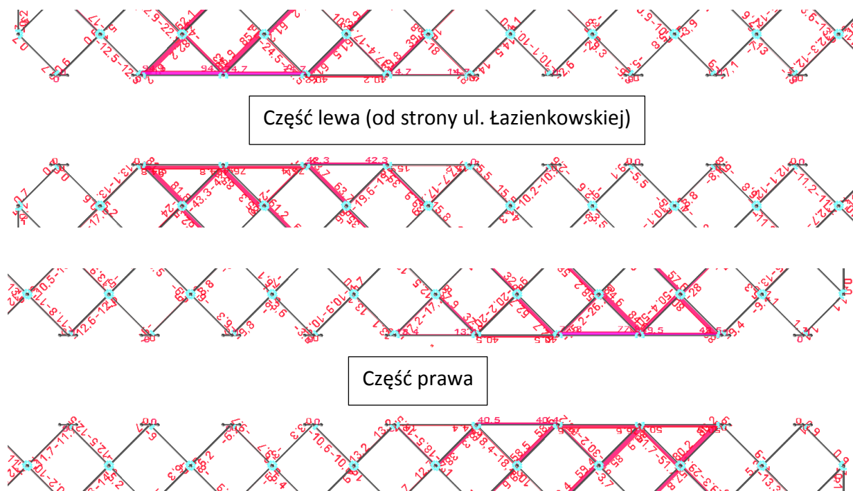
Rys. 3.3. Wykresy sił w, dochodzących do dźwigara, prętach siatki górnej przekrycia „Almos”.
