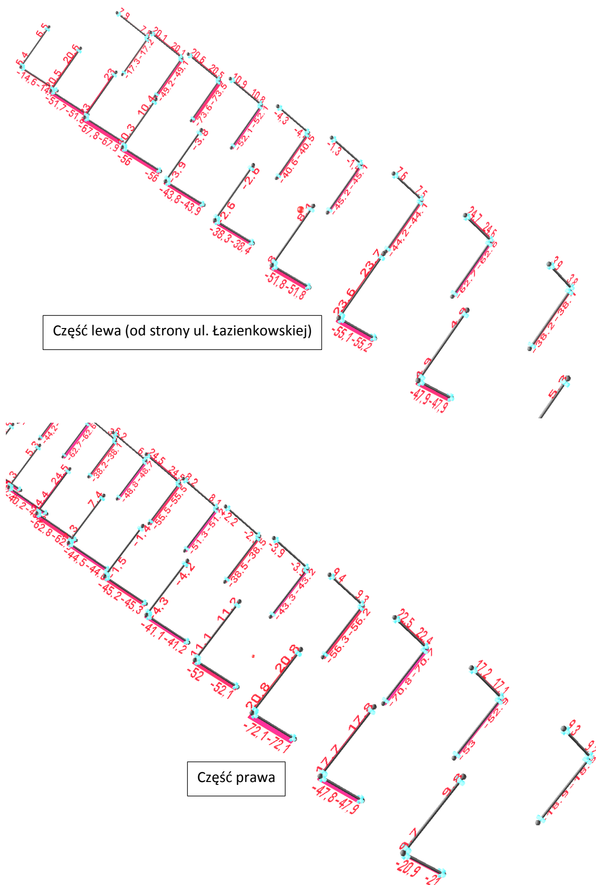
Rys. 3.4. Wykresy sił w, dochodzących do dźwigara, prętach skratowania przekrycia „Almos”.
